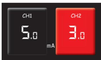
**Attention** : Verrouillage automatique des intensités. Pour déverrouiller baisser l'intensité puis remonter au niveau souhaité.
